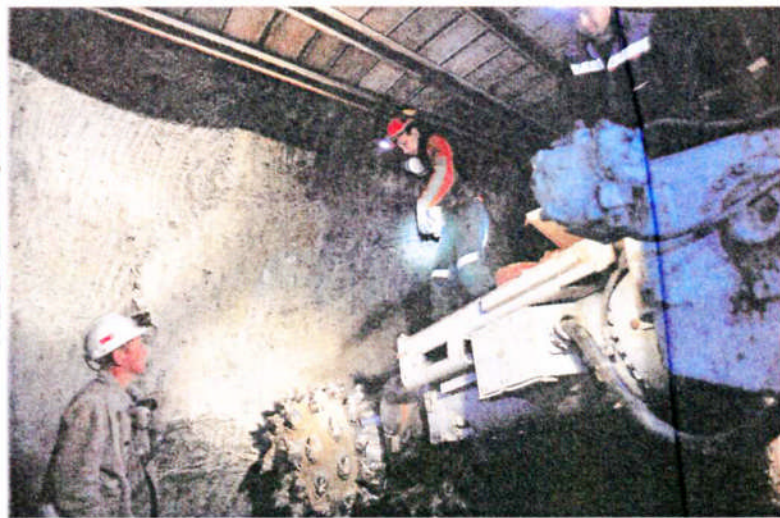
③インテルナツィオナリヌイ鉱山の地下約600mでダイヤが含まれる鉱床を掘削する掘削機。ロシア・サハ共和国のミールヌイ②世界有数の規模を誇るウダーチヌイ鉱山で採れたダイヤモンドを含んだ鉱石。同共和国のウダーチヌイ、いずれも西村大輔撮影
